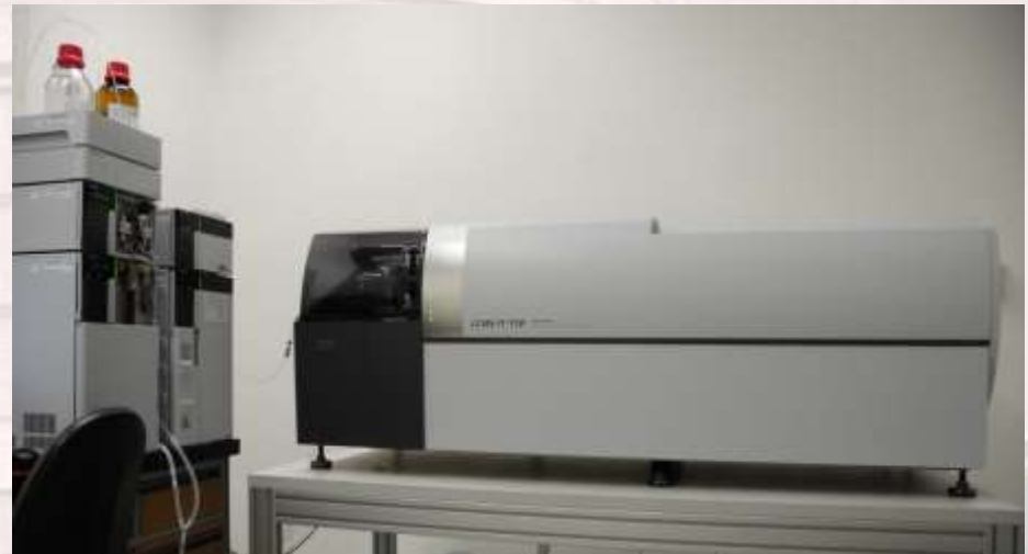
LCMS-IT-TOF analyzátor použitý na analýzu peptidov získaných enzymatickým štiepením trypsínom
